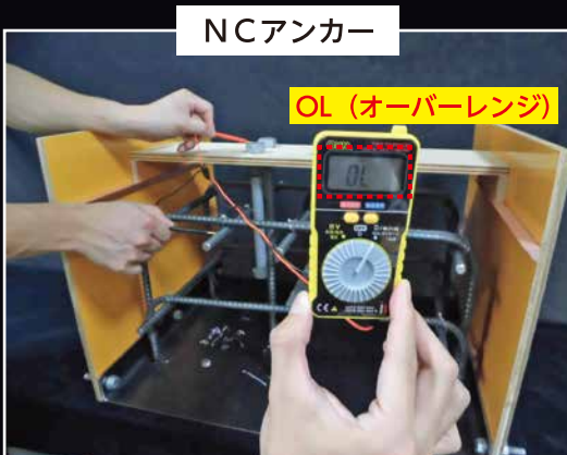
導通していない
